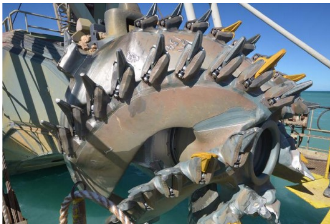
Figura 22 – Desagregador de uma draga de sucção e recalque do tipo cortadora. Fonte: Boskalis Dredging & Marine Experts.
